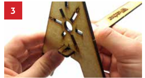
3 Encaixe a trave central A na lateral do nock, como na imagem, de forma que seja possível ver as duas letras.
