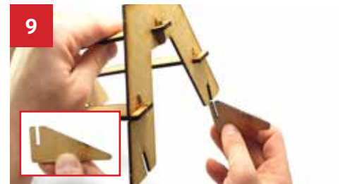
9 Encaixe os suportes na base. Dessa forma o gabarito não tomba quando construir flechas muito pesadas.
