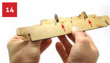
14 Encaixe a régua grande nas duas peças R . Pressione com firmeza até que as duas régua fiquem alinhadas.
