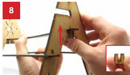
8 Utilize as peças em formato U para travar a trave central A .
