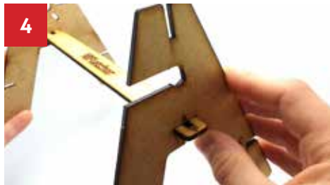
4 Encaixe a outra lateral na trave A , como na imagem, de forma que seja possível ver as duas letras.
